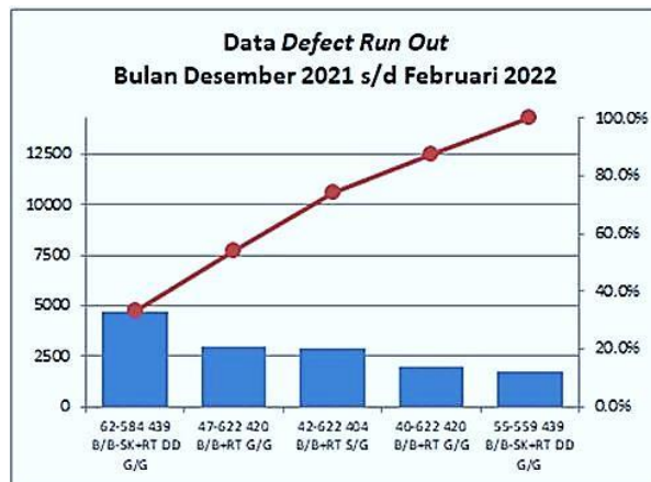
Gambar 3. Grafik Diagram Pareto untuk 5 Besar Defect Run Out
